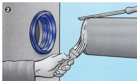
2 Chanfreiner le bord du tuyau à raccorder et lubrifier.
