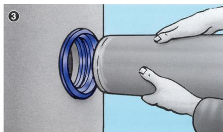
3 Centrez l'extrémité du tuyau et poussez-le dans le joint, de sorte que l'extrémité du tuyau affleure la paroi intérieure.
