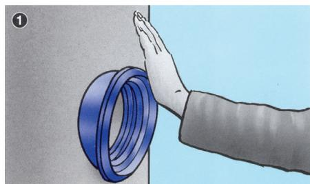
1 Enfoncez le joint F-91 dans le trou. Ne pas utiliser de lubrifiant.
