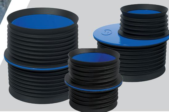
**La gamme Icon Pushfit est composée de six variantes conçues pour réaliser un raccordement droit de tuyaux DN100 et DN150, ou une réduction de tubes DN100/DN150 quel que soit leur matériau via leurs surfaces internes.**
