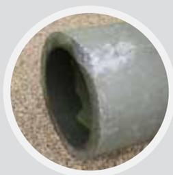
Lorsque la dégradation d'une surface empêche une étanchéité externe fiable
